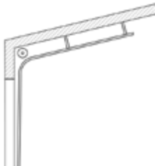
Abb.7. Standardumlenkung mit Dachfolge
